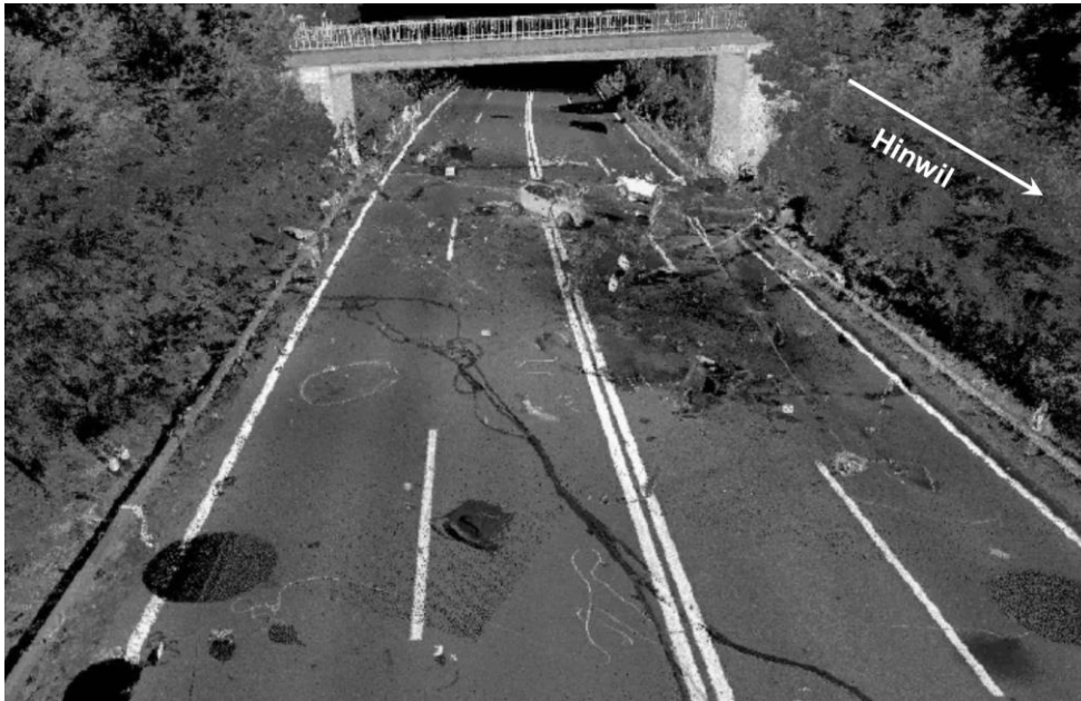
Abbildung 40: Per terrestrischem Laserscan dreidimensional erhobene Umgebung eines Verkehrsunfalls (Bild: Forensisches Institut Zürich, 3D-Zentrum Zürich)
