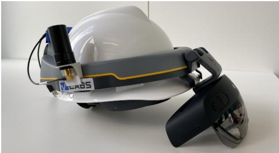
Abbildung 37: Der V-Labs Helm mit einer Microsoft HoloLens 2 und einem GNSS/RTK-Aufbau (Bild: V-Labs)
