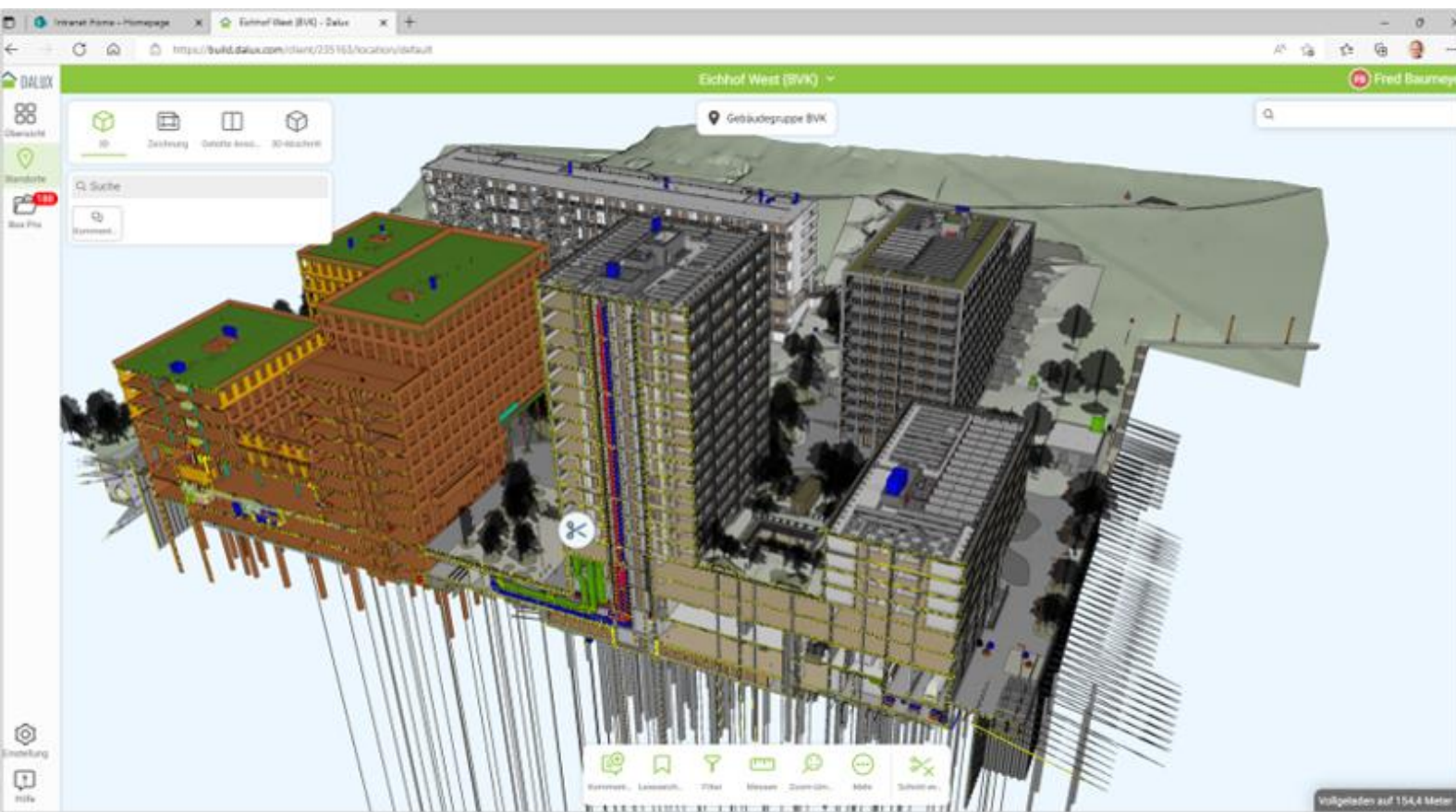
Screenshot de la plateforme Dalux / Planifier sur la base d'un modèle -> Export de plans 2D pour le chantier
