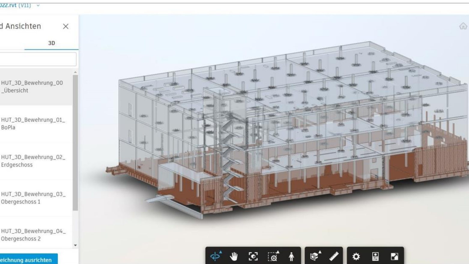
Screenshot de la plateforme ACC/ Planification à partir d'un modèle -> Export de plans 2D pour le chantier
